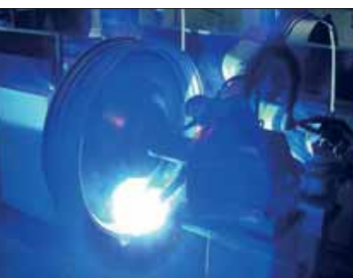
Die Radschüssel wird vom Roboter verschweißt.
